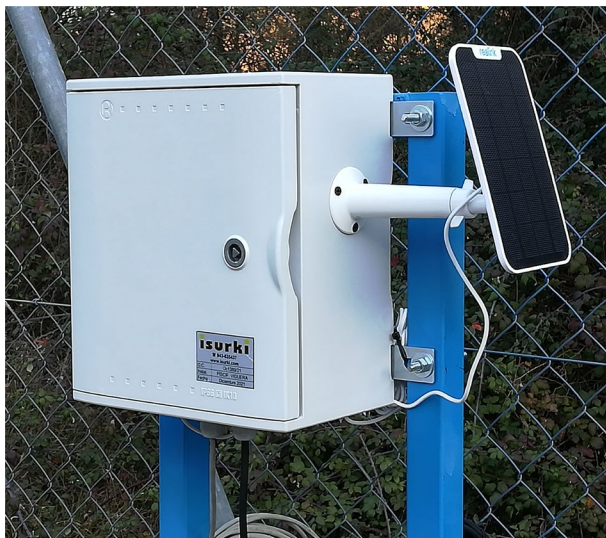
↑ Prevención de Legionela en red ACS mediante medición y registro de temperatura. ⇐ Ejecución especial en armario IP66, 300x265x165mm, con bornero, y panel solar opcional.
