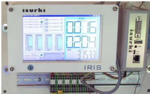
IRIS BOX PC con pantalla táctil 7" IKUS en una aplicación de aforo de canal abierto con telecontrol
