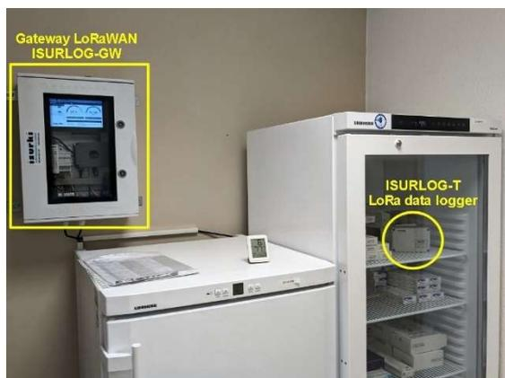
↑ Gateway LoRaWAN **ISURLOG-GW** en ejecución en armario (izquierda) junto a un data logger **ISURLOG-T** en el interior de un frigorífico.
