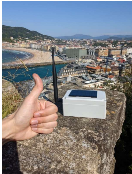
Unidad Isurlog alimentada con panel solar integrado en el monte Urgull de San Sebastián enlazando vía LoRa con la sede de ISURKI a 13 km.
