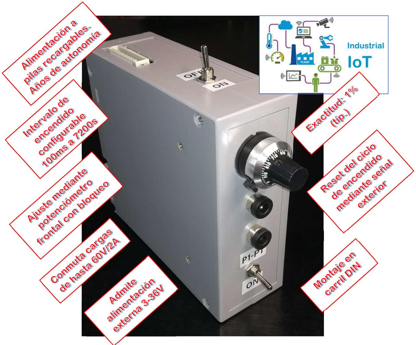
**IRIS TIMER** es un temporizador electrónico industrial que permite controlar el encendido/apagado de cargas de hasta 60V/2A, lo que posibilita reducir su ciclo de consumo al mínimo imprescindible manteniendo la carga alimentada exclusivamente en el intervalo de tiempo en el que ejecuta funciones operativas y reduciendo a cero el consumo de la instalación mientras éstas no se efectúen.
