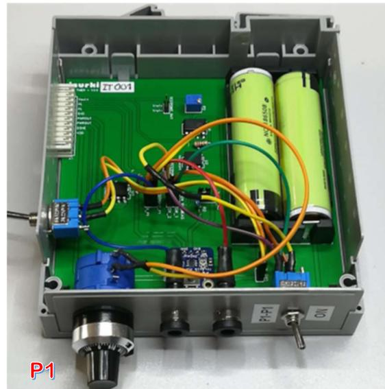
**IRIS TIMER** : interior de la unidad con la tapa retirada. Se observan las pilas de alimentación
