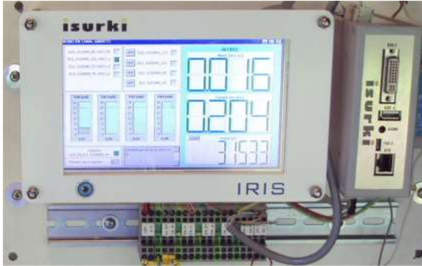
IRIS BOX PC QFH con pantalla táctil 7" IKUS en una aplicación de aforo de canal abierto con telecontrol
